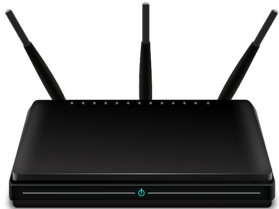
Si va a conectar una LAN a otras LAN y a Internet para formar una WAN, un enrutador (router) facilita la conversión y reversión de la señal.
